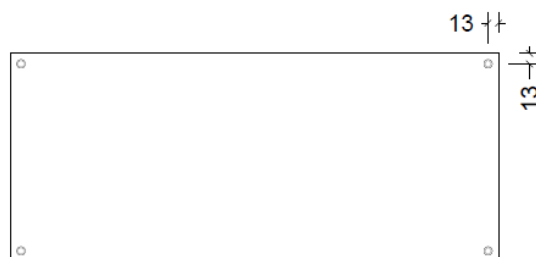
Type C: Påskruning og tape (standard)
