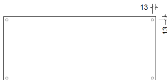
Type C: Påskruning og tape (standard)
